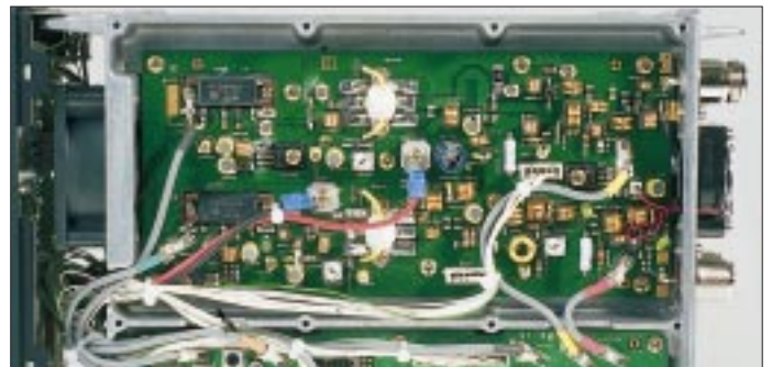
Die Kammer für die drei Endstufen, KW plus 6 m, 2 m bzw. 70 cm, befindet sich links oben vor den Antennenbuchsen.
