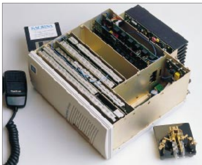
Bild 5: Im Innenleben des Transceivers äußert sich das professionelle und gediegene Gesamtkonzept. Alle Leiterplatten sind steckbar und mehrheitlich durch Weißblechgehäuse abgeschirmt.
