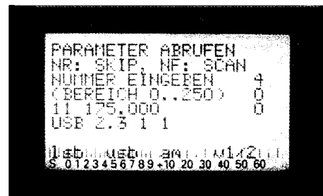
In den Speicherplätzen werden sämtliche Empfangsparameter abgelegt. Nur die Lautstärke muß man von Hand regeln.
