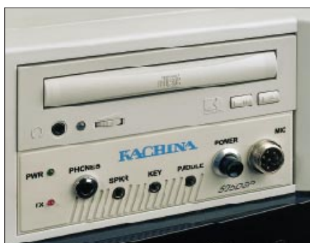
Bild 4: Kachina-PC-Steuer-einschub in einem 5,25"-Schacht. Die Front enthält neben dem Einschalter lediglich die Buchsen für Mikrofon, Lautsprecher und die beiden Tastenanschlüsse sowie zwei Leuchtdioden.
