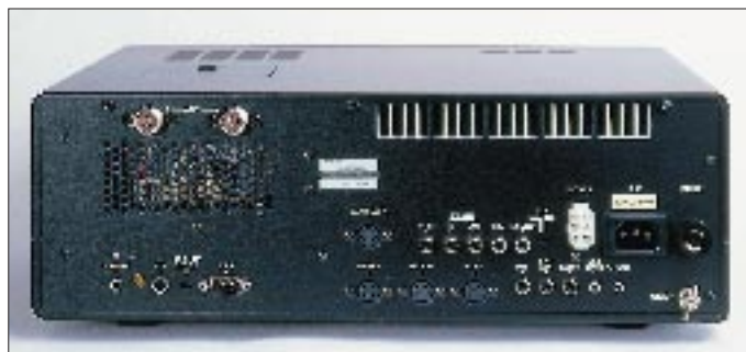
Bild 4: Dieser schöne Rücken erfreut den Liebhaber digitaler Betriebsarten, und wer sein Gerät per Computer steuern möchte, wird die CAT-Buchse zum direkten Anschluß an COMx schätzen.
