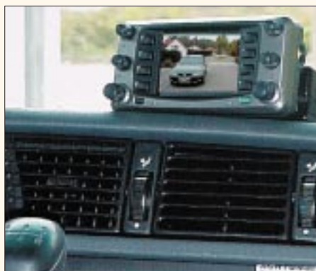
Bild 6: Bedienteil mit eingespeistem Video-signal von der Heckkamera
