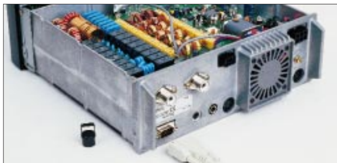
Bild 2: Auf der Rückseite warten nicht nur zwei Antennen und ein Computer auf Anschluß. Nicht zu übersehen – das CE-Zeichen. Der recht leise Lüfter schaltet sich nur bei Bedarf ein.
