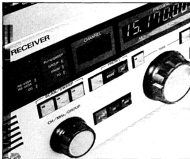
Um diese beiden Knöpfe dreht sich die Frequenzabstimmung: links in Schritten zu / MHz, recht in kleinsten zu einem Hertz.
