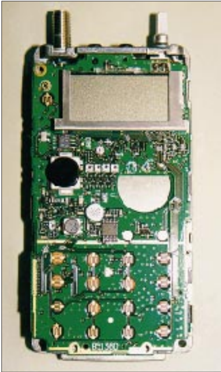
Ein Blick ins Innere des IC-T81E, hier auf die Frontleiterplatte mit Wipptaste und Mikrophonkapsel. Wegen der durchgängigen Bestückung mit winzigsten SMD-Teilen fällt die Bestimmung einzelner Baugruppen schwer. Die gesamte Schaltung findet auf nur zwei doppelseitig bestückten Platinen Platz. Fotos: Autor
