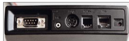
Bild 2: Gerätefront mit neunpoliger D-Sub-Verbindung, 2,5-mm-GPS-Klinke, Mini-DIN-TNC-Anschluß, Westernbuchsen für Mikrofon und Bedienteil sowie versenktem Resetaster.
