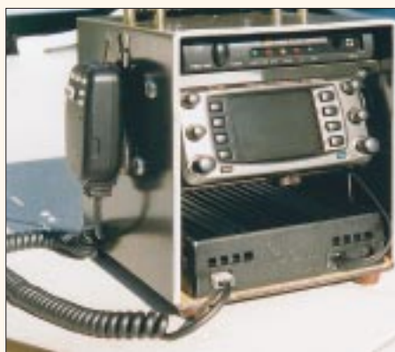
Bild 17: SSTV/p-Ausrüstung von DG5DLE mit IC-2800H, Eigenbau-Rack und TSC-70P-SSTV-Konverter. Gut sind die Steckverbindungen an der Vorderseite des IC-2800H zu erkennen. Fotos: Werkfotos (5), FA (4)
