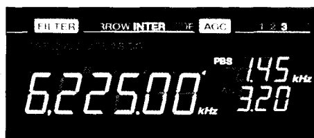
Das Display zeigt nicht nur die aktuelle Frequenz, sondern auch die numerischen Werte für PBS, Bandbreite und AGC an.
