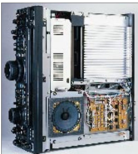
Bild 2: Die Ansicht von oben in den geöffneten Transceiver gibt nicht viel vom Innenleben preis. Das Endstufenmodul mit seinen Kühlrippen und das Netzteil sind durch einen leisen Tangentiallüfter voneinander getrennt.
