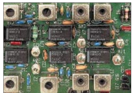
Bild 4: Rückseitige Einblicke in den K2 (oben) Bild 5: bistabile Relais für die Eingangsbandfilter
