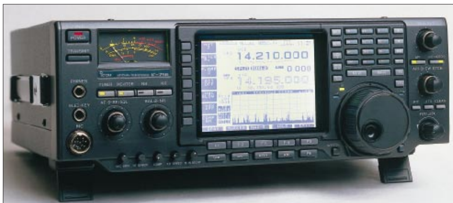
Bild 1: Die Front des IC-756 wird von dem großen LC-Display beherrscht, das diverse Einstellungen und insbesondere wahlweise das hochauflösende Spektroskop darstellt.
