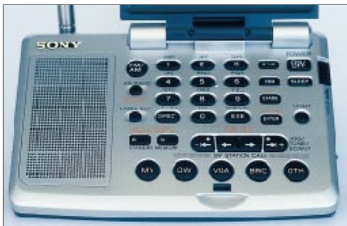
Das übersichtliche Tastenfeld des ICF-SW07 ermöglicht trotz der geringen Ausmaße des Empfängers eine komfortable Bedienung, so z.B. direkte Frequenz-eingabe. Das Bedienungs-konzept gleicht dem anderer Weltempfänger aus dem Hause Sony.
