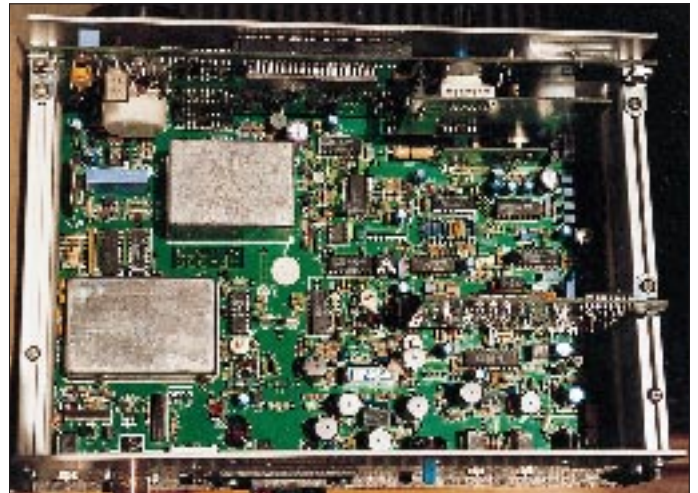
Bild 2: Alles integriert: Sämtliche Bandbreiten sowie die FM- und Detektor-Einheiten sind beim HF-225 Europa bereits eingebaut.
