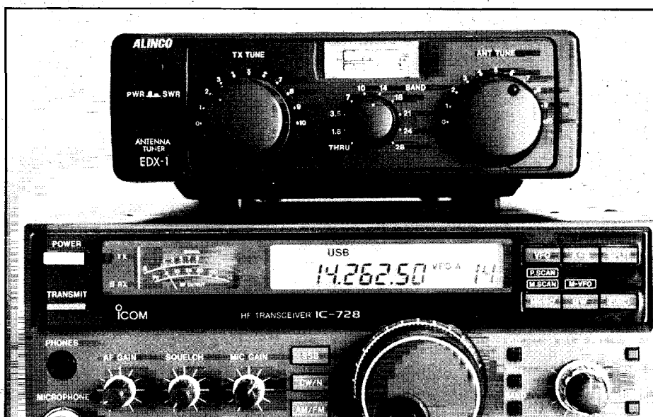
Der Alinco EDX-1 Antennentuner eignet sich für den Betrieb an beliebigen Kurzwellen-Transceivern des Amateurfunks. Die Beschränkung auf die für den Amateurfunk zugeteilten Frequenzbereiche sorgt für eine zusätzliche Vorselektion und gewährleistet mit Hilfe der integrierten elektronischen Meßschaltung für SWR und Ausgangsleistung einen raschen Abstimmvorgang.
