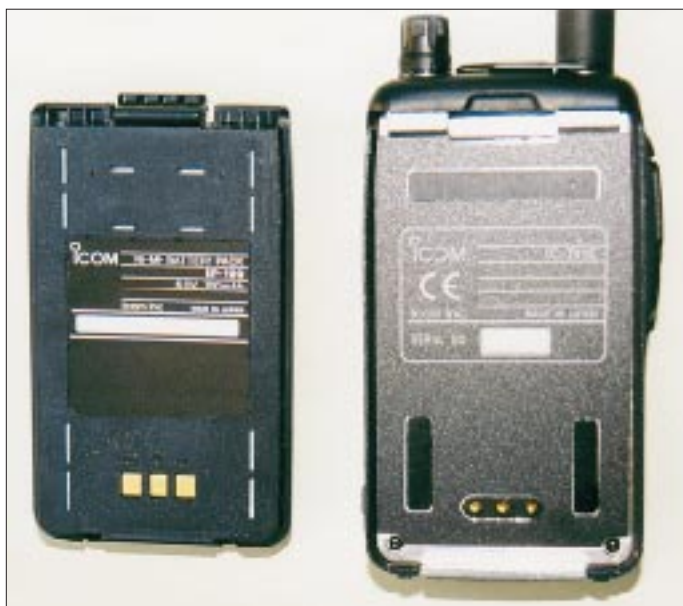
Der beiliegende NiMH-Akkupack wird sicher an der Druckguß- Rückwand eingehakt.
