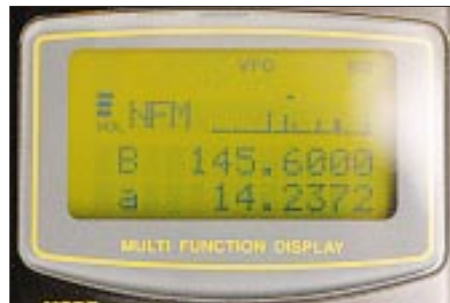
Display des DJ-X10 mit der Scope-Darstellung
