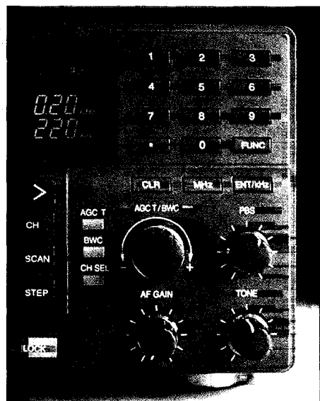
Auf der rechten Frontseite befinden sich u.a. die Steher für AGC, Bandbreite (BWC) und Paßband-Shift (PBS), mit deren Hilfe sich erstaunliche Ergebnisse in besonders kniffligen Empfangssituationen erzielen lassen.
