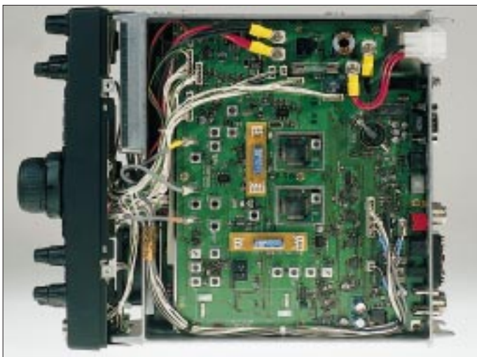
Die Kammer für die drei Endstufen, KW plus 6 m, 2 m bzw. 70 cm, befindet sich links oben vor den Antennenbuchsen.
