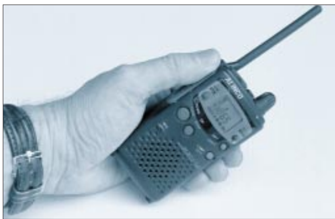
Gar niedrig anzuschauen und leicht mit Scall oder Cityruf zu verwechseln: Alincos neues Mikro-Handy DJ-S41 für 70 cm.
