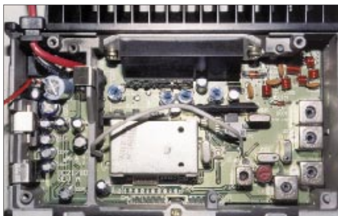
Ein Blick ins Innere: auffällig insbesondere der abgeschirmte VCO und das große Endstufenmodul
