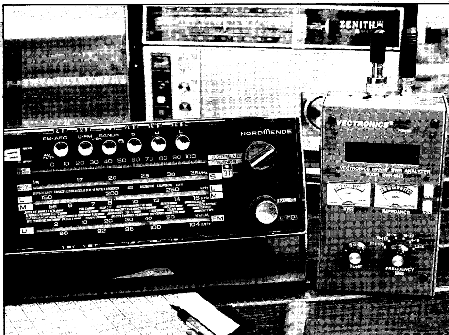
Radios und Weltempfänger mit Skalenzeigerabstimmung lassen sich bequem auf Exaktheit der Anzeige überprüfen und bei zuviel Abweichung natürlich auch sofort abgleichen – sofern ein Manual mit Lageplan der Abgleichpunkte zur Hand ist.
