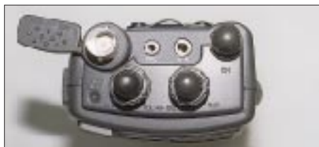
Ansicht von oben: BNC- und abdeckbare Klinkenbuchsen, Hauptabstimmknopf und koaxial angeordnete Drehsteller für Lautstärke und Rauschsperrleuchte plus „S/E-Leuchtdiode“ prägen das Bild.
