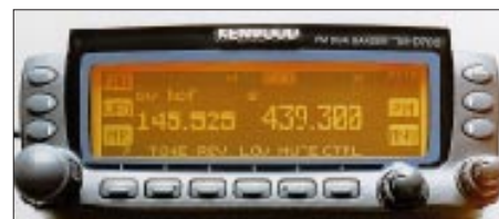
Bild 6: Das Display bernsteinfarben illuminiert; jede Taste durchleuchtet. Kürzel für die jeweils gültigen Funktionen erleichtern die Bedienung.
