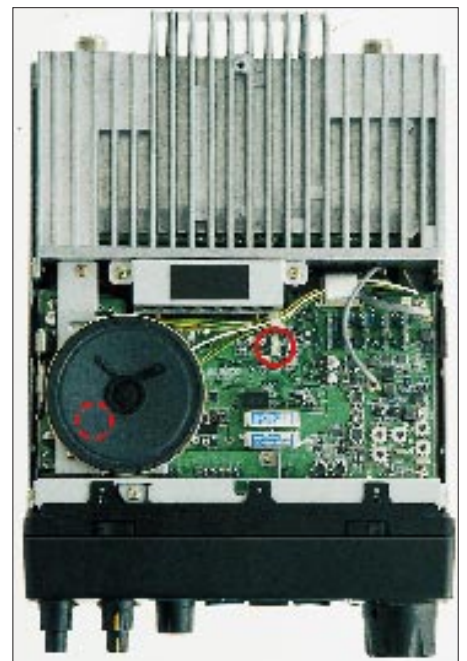
Bild 2: Das Innenleben des DX-70, wenn die obere Gehäusehälfte abgenommen ist. Im roten Kreis der Umschalter für die KW-Ausgangsleistung (100/50 W); der gestrichelte markiert die Lage des Mikrofon-Stellers, der sich unter dem Lautsprecher befindet
