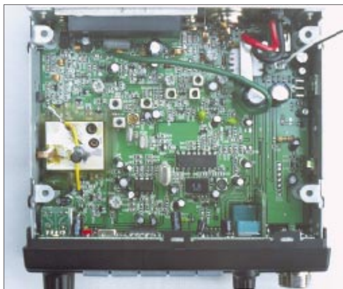
Blick von unten in das aufgeräumte Innenleben des AE 550. An der Rückwand (mit dem Kühlkörper verbunden) das Sender-Leistungsmodul MM 57737 Fotos: DK7ZB
