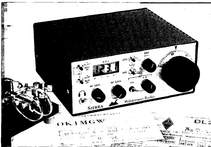
Bild 2: Frontansicht des Transceivers mit der Zusatzbaugruppe digitale Frequenzanzeige/elektronische Taste (für verschiedene Aufrüstungsgrade stehen unterschiedliche Frontplatten zur Verfügung).
