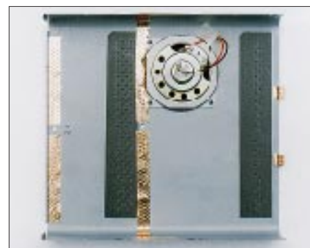
Auf die Abdeckbleche sind zur besseren internen Abschirmung noch Kupferflächen aufgeklebt.
