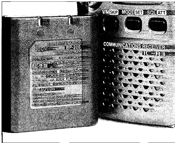
Zum Lieferumfang gehört ein Lithium-Ionen-Akku, der im Empfänger geladen wird. Als Zubehör ist auch ein externes Ladegerät erhältlich.
